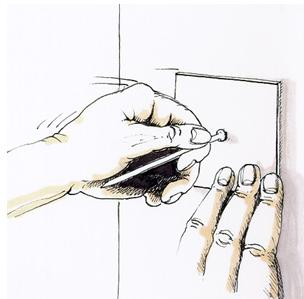
Placez le support dans la position souhaitée et appuyez la base contre la surface à isoler.
